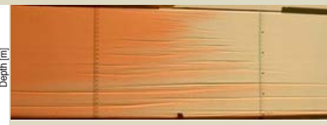
(二重拡散対流による貫入の室内実験; 野口尚史による)
